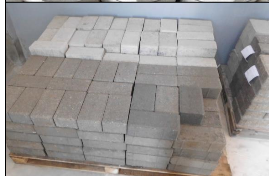
Hasil Pemanfaatan Limbah B3 (Produk Paving Block)
